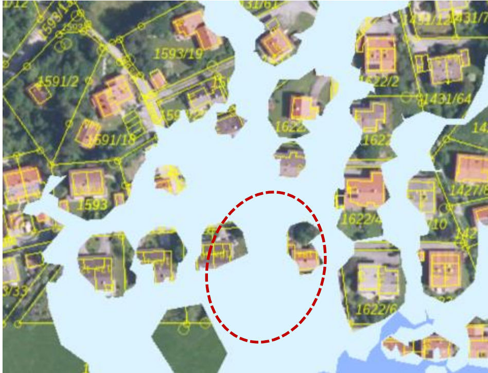
Abb. 6 Lage des Plangebiets (roter Kreis), Hochwassergefahrenfläche HQ extrem (hellblau) und festgesetztes Überschwemmungsgebiet HQ 100 (dunkelblau) ohne Maßstab, Quelle: Bayerische Vermessungsverwaltung, Stand 09/2023
